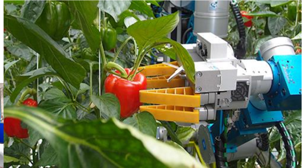
Brazo robótico para cosecha de fruta
